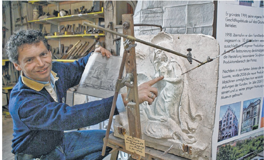
Punkt für Punkt: Andreas Scherer demonstriert, wie das Modell mittels Punktiergerät auf das Original übertragen wird.
